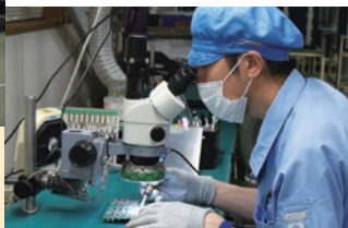
上：整理整頓された那須工場の基板実装ライン。5段階の検査工程を通じて、高品質な電子回路基板を提供している。 右：顕微鏡をのぞき、1/10ミリ精度での手はんだづけも行う。
